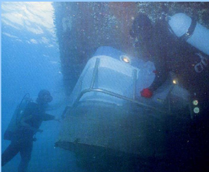
図-2 水中船体清掃機（SEA DOG）油圧式（回収装置付）
